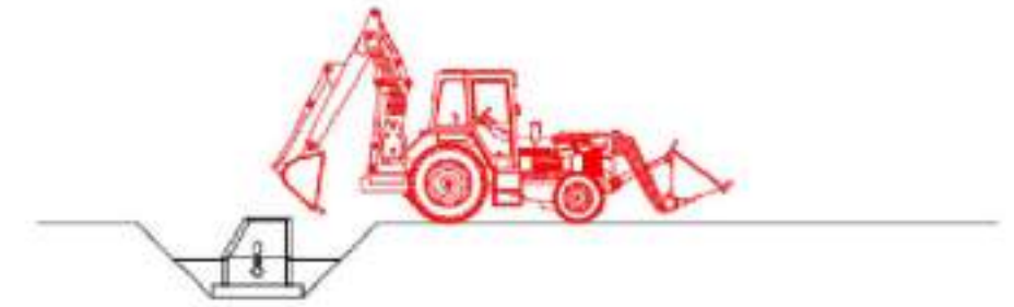
6. Reblert del pou amb retro-excavadora en longades
