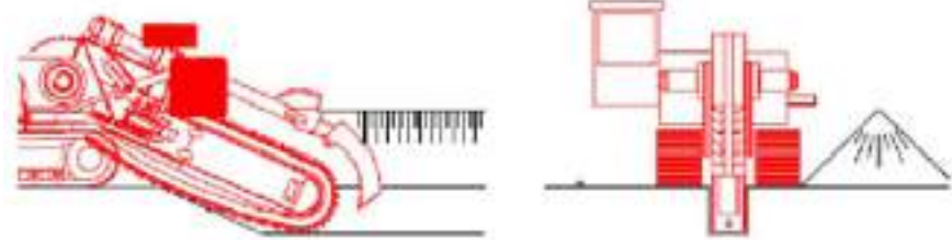
4. Excavacions de rases amb rasadora
