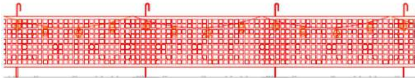
MALLA TÀRONJA DE POLIETILÈ AMB BALISES PENJADES AMB LLUMS INTERMITENTS
