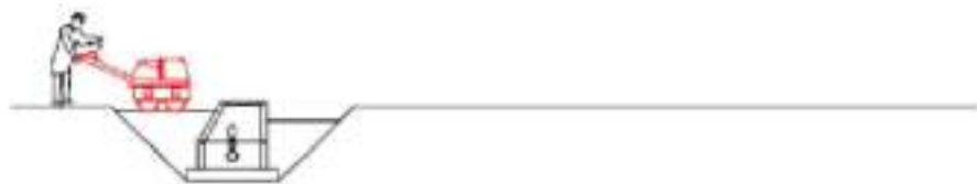
7. Compactació de terres al voltant del pou
